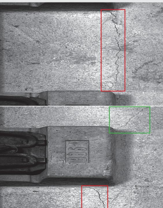
CrackCheck ist ein automatisches Inspektionssystem, das bei einer Geschwindigkeit von über 100 km/h Betonschwellen und „feste Fahrbahn“ auf Risse untersucht und als Ergebnis ein Streckenzustandsprotokoll erzeugt, das dem Anwender mit hoher Qualität und Sicherheit, in kürzester Zeit einen objektiven Status der inspizierten Strecke erzeugt. Mittels modernster Bildverarbeitungstechnologien stellt CrackCheck sicher, dass die Oberbauinspektion schneller, sicherer und verlässlicher wird.
